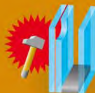
Vitrage de protection.
